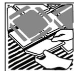
Durante la instalación de la obra es muy importante proteger el piso con las cajas extendidas, a efecto de no dañar el producto.
