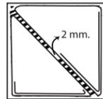
Se recomienda colocar una boquilla mínima de 2 mm. (no usar juntas de humo negro o carbono), aplicándola sólo sobre la junta y no sobre toda la superficie de la pieza.
